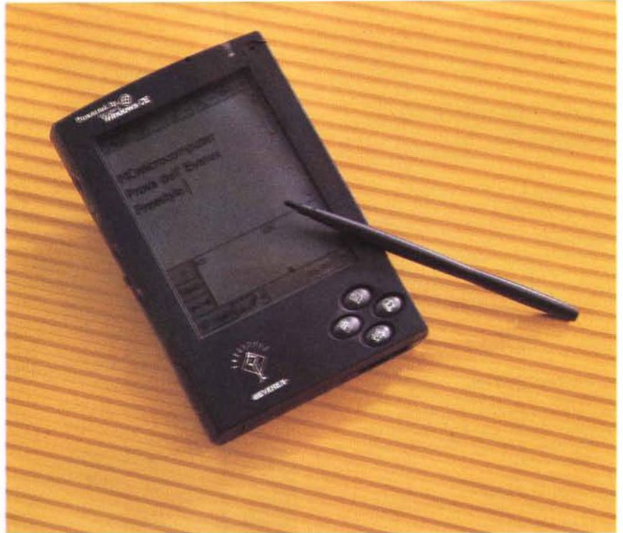
Il frontale dell'Everex è occupato dal monitor verticale 240x320 con sotto i tasti per attivare immediatamente i programmi principali. Il riconoscimento della scrittura è buono, i caratteri possono essere scritti in maiuscolo o minuscolo in vari modi. La zona riservata al riconoscimento è divisa in tre aree: minuscole, maiuscole e numeri.
